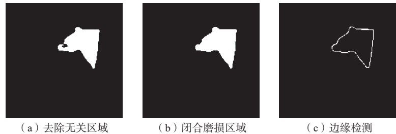
图15 磨损区域优化与边缘提取处理结果
